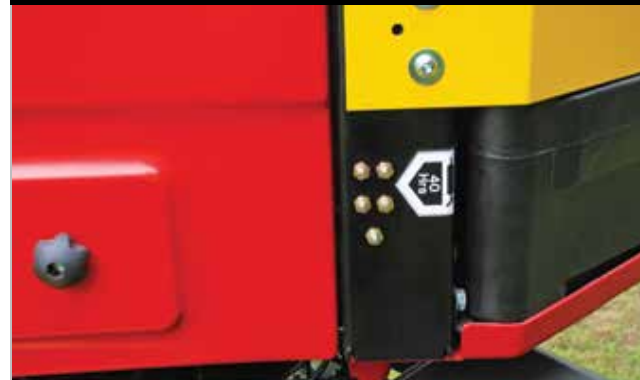
Центральный пост смазки
