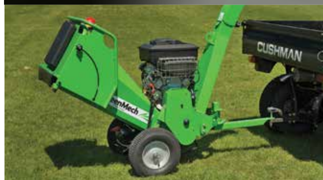
Прицепление для транспортировки в работе
